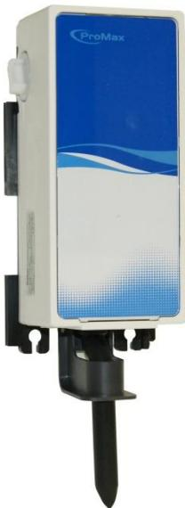
**PROMAX** est utilisé pour diluer les détergents en utilisant un système de « Venturi ». L'avantage de ce système est le mélange eau/produit chimique qui crée un produit prêt à l'emploi.
